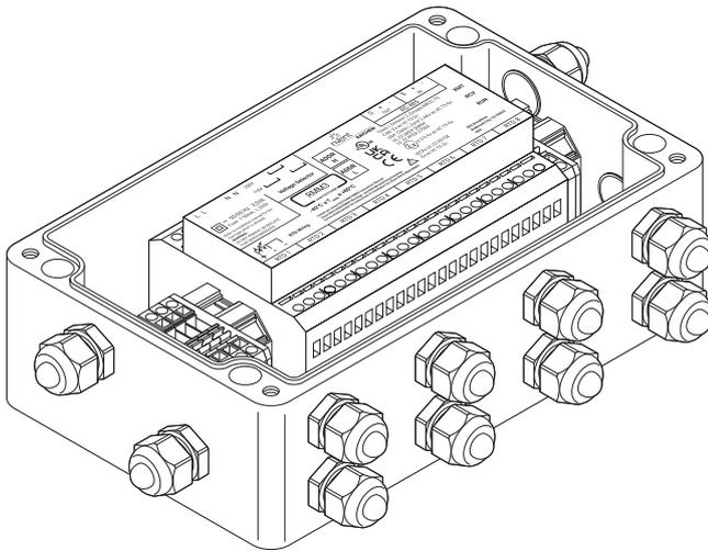
Les modules de surveillance à distance (RMM3) contrôlent la température des systèmes de la famille nVent RAYCHEM Elexant et NGC. Sur chaque module nVent RAYCHEM RMM3 peuvent être connectés au maximum huit sondes de température Pt100 qui mesurent la température ambiante ou la température des tuyauteries. Les modules RMM3 sont reliés à un seul terminal d'interface utilisateur nVent RAYCHEM assurant de manière centralisée la surveillance des températures.
