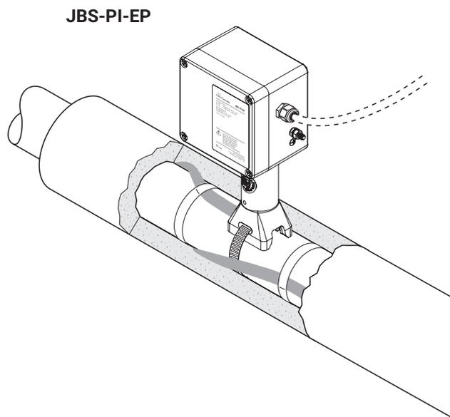
Набор nVent RAYCHEM JBS-PI-EP предназначен для подключения греющих кабелей nVent RAYCHEM XPI промышленной серии непосредственно к источнику питания без использования холодных проводов и с определенными ограничениями по мощности и току.
