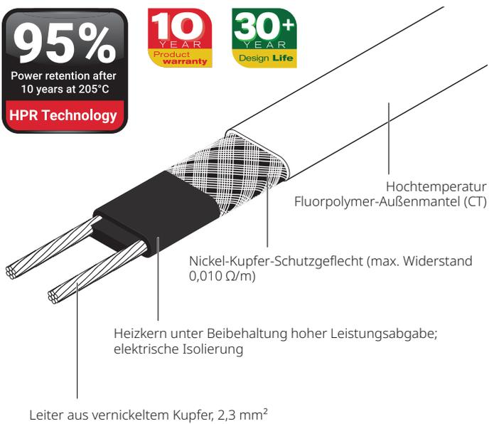
Das selbstregelnde Heizband Raychem HTV ist für den Frostschutz oder zum Halten der Prozesstemperatur bei Rohren und Behältern mit durchgängig sehr hohen Betriebstemperaturen (205 °C) ausgelegt.
