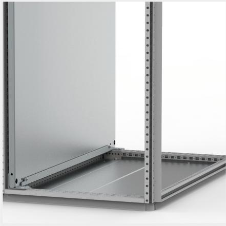
**Description:** Crée une surface d'installation couvrant toute la largeur de l'armoire. Installation très simple grâce à des profilés coulissants MTS se montant par le coté. La largeur nominale est égale à celle de l'armoire. Lors de la juxtaposition d'armoires, les plaques MPW peuvent être assemblées et introduites ensemble dans l'armoire. Montage complètement en fond d'armoire impossible.
