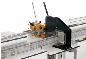
Optimiser les ressources et réduire les déchets avec des machines de découpe de traverses et de gaines de câbles
