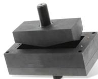
A ferramenta de perfuração de chapa metálica facilita e acelera a marcação e criação precisas de derivações sem aparas ou lascas.
