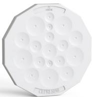
Installazione rapida e semplice senza utensili per cavi o tubi pneumatici in entrata o in uscita da una cassa. Sistema a innesto progettato per pareti di spessore compreso tra 1,5 e 2,5 mm.
