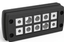
Sistema di passacavi modulare veloce, sicuro e versatile montato e gestito dall'esterno del quadro. È dotato di guarnizioni di sicurezza e serracavi per cavi pre-assemblati e non assemblati, con o senza connettori. Il sistema viene fornito con inserti predisposti per adattarsi a piccoli anelli di tenuta.
