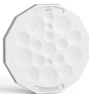
Installation rapide, facile et sans outils pour les câbles entrants et sortants ou pour les conduites pneumatiques dans une armoire. Système à clips conçu pour des parois de 1,5 à 2,5 mm d'épaisseur.
