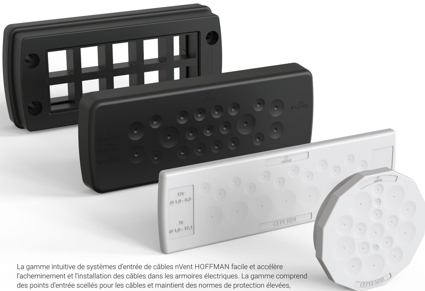
La gamme intuitive de systèmes d'entrée de câbles nVent HOFFMAN facilite et accélère l'acheminement et l'installation des câbles dans les armoires électriques. La gamme comprend des points d'entrée scellés pour les câbles et maintient des normes de protection élevées, IP54 et IP66, contre la poussière, l'eau et les vibrations.
