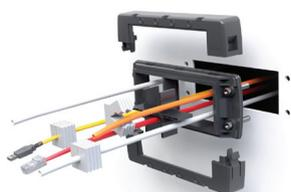
El sistema de entrada de cables modular rápido, seguro y versátil proporciona juntas seguras y protección contra tirones para cables premontados y sin montar con o sin conectores. Hecho de un plástico reforzado con fibra de vidrio resistente. El sistema viene preparado con incrustaciones para colocar pequeños ojales.
