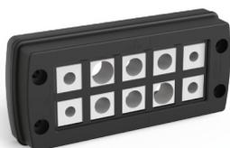
Sistema de entrada de cables modular rápido, seguro y versátil que se monta y gestiona desde fuera del armario. Proporciona juntas seguras y protección contra tirones para cables premontados y sin montar con o sin conectores. El sistema viene preparado con incrustaciones para colocar pequeños ojales.
