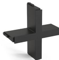
Mit den einrastenden Inlays kann die Dimensionierung der Rahmenöffnung an die verwendete Tülle angepasst werden. Ein hörbares „Klicken“ bestätigt die korrekte Installation. Die flexible Konfiguration der Kabeleinführung ermöglicht es Ihnen, verschiedene Anforderungen für Kabel, Leitungen, Schläuche, pneumatische und hydraulische Leitungen zu erfüllen.
