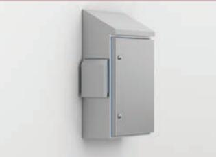
Ayudan a proteger los ventiladores con filtro en entornos de lavado contra la entrada de agua. La cubierta puede retirarse fácilmente para las operaciones de mantenimiento y sustitución de juntas, y también puede abrirse en un ángulo de 35° para facilitar la limpieza del filtro. Al estar inclinada, la cubierta evita que se acumulen líquidos y otros residuos. Plegado y sellado por soldadura.
