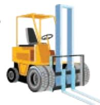
**Durante la movimentazione utilizzare una velocità molto ridotta.** Movimentare la macchina con serbatoio completamente svuotato dall'acqua.
