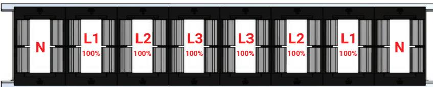
Optimierte Leiteranordnung (Laststrom ausgeglichen)
