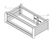
Этот комплект можно использовать для покрытия задней стороны и дополнительного экранирования между боковой панелью и задними панелями.
