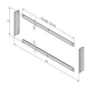
Установка передней рамы обеспечивает контакт между блочными каркасами и узлами. Она должна использоваться, если заказчик выбрал комплект для горизонтального монтажа печатной платы.
