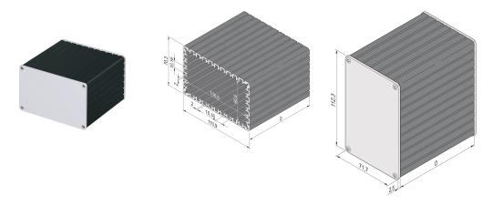
Прямоугольный корпус из алюминиевого профиля позволяет пользователю вставлять 4 стандартные печатные платы (высота 100 мм х глубина 160 мм). Платы устанавливаются в пазы в корпусе из алюминиевого профиля. Обе стороны покрываются передними панелями толщиной 2,5 мм.
