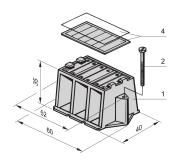
Монтажные кронштейны для шин или модулей шин представляют собой изолированные от цепи нагрузки монтажные блоки для направляющих реек заземления. Также доступны адаптеры с заданными номинальными токами, которые подают ток нагрузки на загрузочные устройства через проводные соединения.
