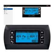
Блок индикации позволяет выполнять локальную конфигурацию, пусковую наладку и мониторинг RackChiller Rear Door. Он включает индикаторную ЖК-панель и 6 функциональные клавиши. Он устанавливается непосредственно на внешнюю панель охладителя и подключается к предварительно проведенным кабелям внутри устройства.
