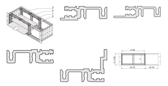
Каркас для установки печатных плат горизонтально позволяет размещать печатные платы 6 U в высоких блочных каркасах 3 U или 4 U или в настольных корпусах. Необходимо добавить переднюю панель, чтобы закрыть область сборки.
