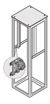
Горизонтальная заглубляющая распорка в глубине шкафа. Устанавливается непосредственно на раму Varistar для прокладки кабелей, повышения жесткости рамы и обеспечения дополнительных точек крепления.
