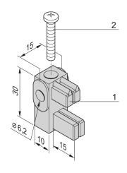
Монтажные кронштейны для шин или модулей шин представляют собой изолированные от цепи нагрузки монтажные блоки для направляющих реек заземления. Также доступны адаптеры с заданными номинальными токами, которые подают ток нагрузки на загрузочные устройства через проводные соединения.
