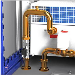
Каждая трубная вставка из нержавеющей стали с внутренним диаметром 1 дюйм оснащена парой логотметрических датчиков охлаждающей жидкости. Датчики подключаются напрямую к контроллеру задней двери RackChiller Rear Door. Это позволяет контролировать тепловые свойства охлаждающей жидкости и эффективность охлаждения, а также дополнительные функции управления температурой.
