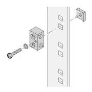
Эти механические зажимы заземления предназначены для использования с кабелями в системах заземления и фиксации. Зажим заземления компании nVent SCHROFF подходит для поперечного сечения 100 мм<sup>2</sup>.
