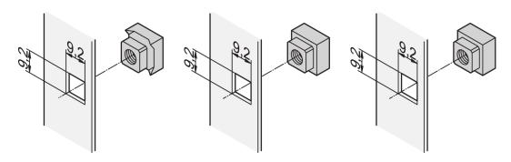
Квадратные гайки имеют более высокую контактную поверхность и не скругляются, в отличие от шестигранных гаек. Для точного, предотвращающего раскручивание, надежного крепления без зазоров используйте квадратные гайки.
