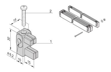
Монтажные кронштейны для шин или модулей шин представляют собой изолированные от цепи нагрузки монтажные блоки для направляющих реек заземления. Также доступны адаптеры с заданными номинальными токами, которые подают ток нагрузки на загрузочные устройства через проводные соединения.
