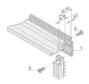
Z-образная рейка для разъема согласно EN 60603-2 (DIN 41612).
