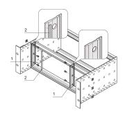
Для вертикального ЭМС-экранирования текстильным уплотнителем между утопленными экранированными передними панелями и боковой панелью.
