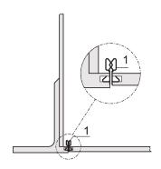
Для вертикального ЭМС-экранирования из нержавеющей стали между утопленными экранированными передними панелями и боковой панелью.
