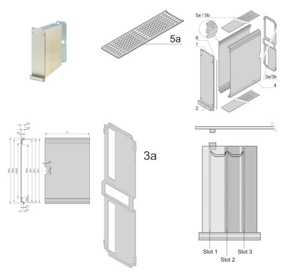
Защищает печатную плату от механических повреждений и электростатического разряда; для европлат; задняя панель с одним вырезом для одного разъема.
