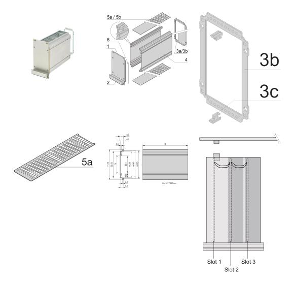
Защищает печатную плату от механических повреждений и электростатического разряда; для европлат; задняя панель с вырезами для нескольких разъемов.
