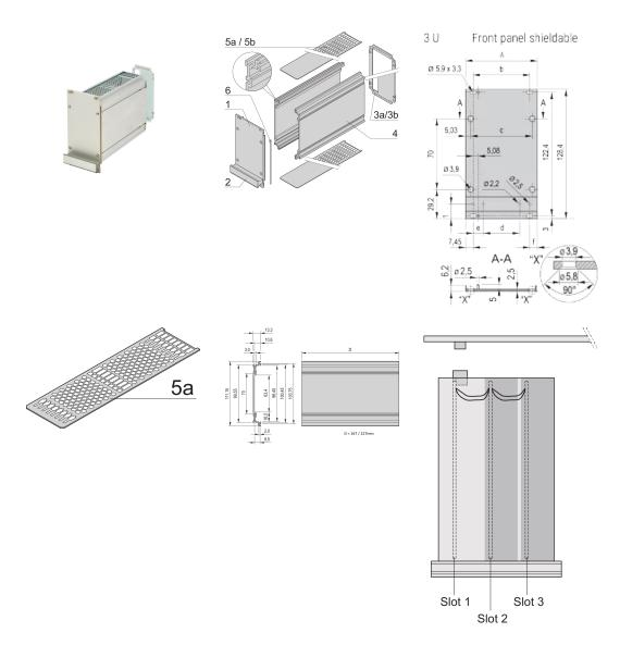
Защищает печатную плату от механических повреждений и электростатического разряда; для европлат; задняя панель с одним вырезом для одного разъема.
