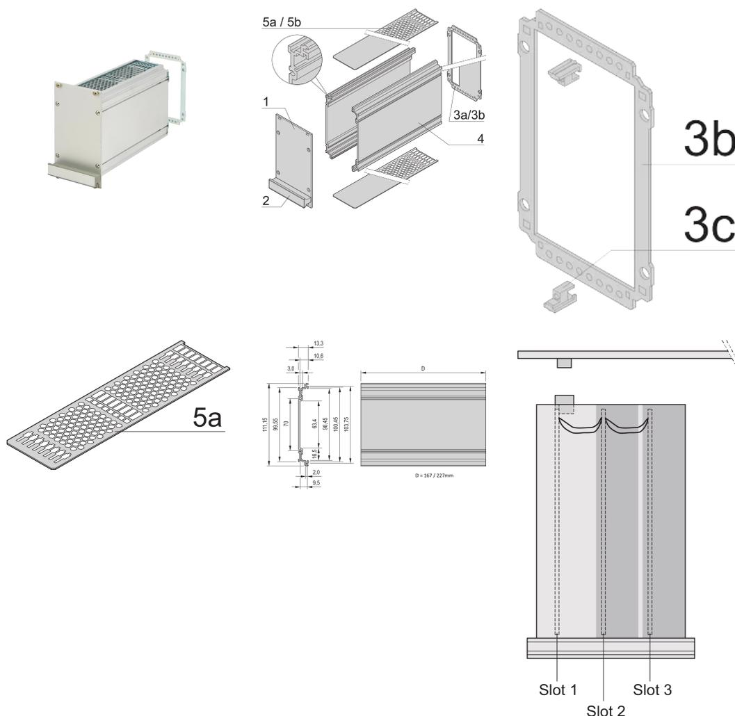
Сменный блок рамного типа, неэкранированный, перфорированная верхняя/нижняя крышка, задняя панель с вырезом для нескольких разъемов.
