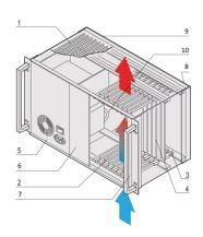
Безвентиляторная система CompactPCI 6 U с вертикальным каркасом для печатных плат на восемь плат 6 U и восемь плат RTM. Встроенный источник питания ATX.
