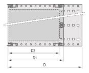
Задний горизонтальный рельс для монтажа объединительной платы с изолирующей полосой
