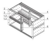
Комбинированный монтаж позволяет разделить блочный каркас или корпус высотой 6 U на секции 2 x 3 U и 6 U. Доступны различные варианты.
