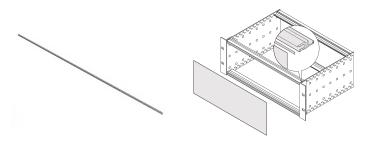
Контактная ЭМС-пружина фиксируется на горизонтальной рейке и обеспечивает токопроводящий контакт с передней панелью или задней стенкой
