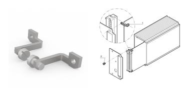
Кронштейн для монтажа печатной платы, для высокочастотного вставного блока рамного типа, комплект с крепежными винтами.
