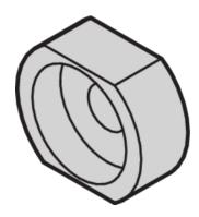
Втулка служит направляющей для винта с проточкой при креплении передней панели.
