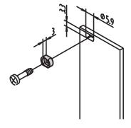
Втулка служит направляющей для винта с проточкой при креплении передней панели.
