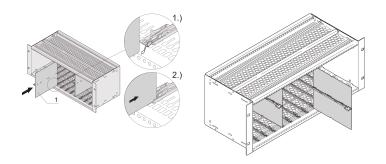
Комплект для разделения вставляется в соответствующее гнездо направляющей nVent SCHROFF MicroTCA и фиксируется в соответствующей шпильке направляющей.
