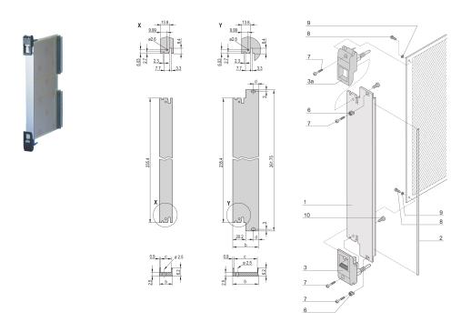
Вставной модуль, с черной ручкой для вставки и извлечения IET, 3 U, монтаж спереди. U-образная передняя панель обеспечивает экранирование с помощью текстильного уплотнителя.
