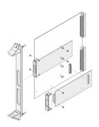
U-образная передняя панель с вырезом для РМС. Возможность экранирования тканевой ЭМС-прокладкой.
