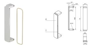
Мезонинная передняя панель вставляется в вырезы передней панели РМС. Доступна в различных вариантах обработки. Для ЭМС-прокладки тороидального сечения.
