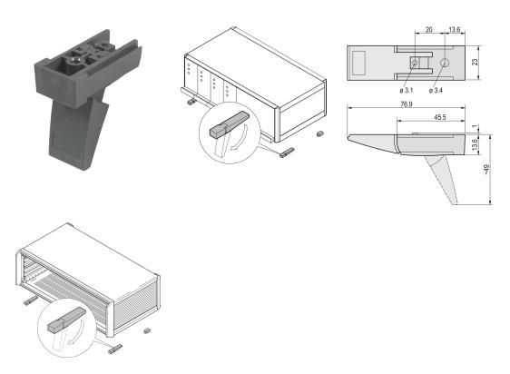
Гибкая и прочная откидная ножка для шасси с несущей способностью 25 кг на ножку. Подходит для RatiopacPRO/-AIR, PropacPRO, CompacPRO, Comptec и Interscale.
