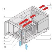
Настольное шасси PXI с вертикальным каркасом для восьми печатных плат 3 U и встроенным источником питания.
