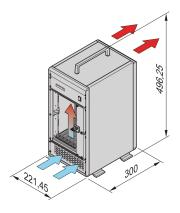
Система Tower для VME64 7 печатных плат VME64x, высота 6 U, 160 мм. Питание системы осуществляется от сменного источника питания. Модуль управления вентилятором контролирует работу вентиляторов, следит за температурой и напряжением.
