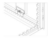
Внутренний фиксатор легко устанавливается без сверления и позволяет снимать заднюю панель только изнутри. Фиксатор предназначен только для применения в системах IP 20.
