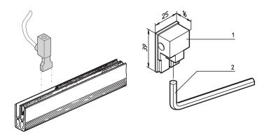
разъем питания для шины обеспечивает внутреннее распределение энерговыделения, предназначенное для уменьшения сложности сервера и обеспечения разъемного соединения, облегчающего сборку, проверку и устранение неисправностей.
