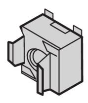
Закладные гайки позволяют использовать гайки и винты разных размеров и легко заменять их в отличие от применения резьбовых отверстий. Закладные гайки легко использовать на материалах, которые слишком тонкие или мягкие для нарезки резьбы.
