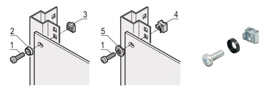
Для стандартного заземления используйте заземляющую гайку и шайбу по крайней мере на одной точке крепления.
